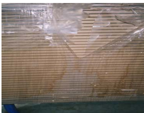
Bild 6 Kondens (fritt vatten) innanför plasten
